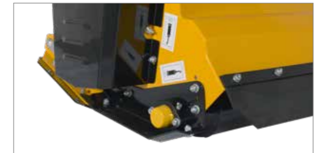
Fint gradueret justerbar støttevalse til dybdeføring.
