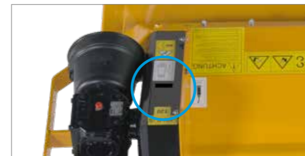
Altid overblik over kileremsspændingen: Kileremsbeskyttelse med kontrolåbning.
