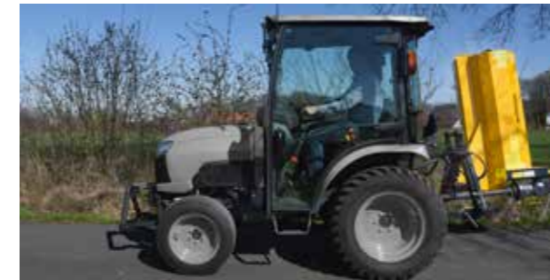
Kort konstruktion for et tyngdepunkt tæt på traktoren.
