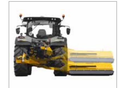
Mulchmaskinens højde kan indstilles hydraulisk. Dermed er det også muligt at mulche plateauer ved siden af traktoren.
