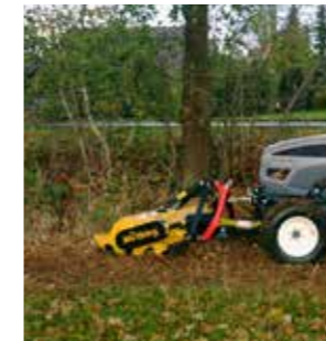
MU-C til frontmontering: Lavere koblingspunkter og en dybtliggende gearkasse (indgangsmdrejningstal på 1.000 eller 2.000 o/min).
