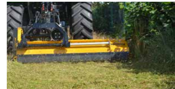
Hydraulisk sideforskydning: Forskudt mulching ved siden af traktoren skaber fleksibilitet ved træer, indkørsler eller andre forhindringer (tilvalg).
