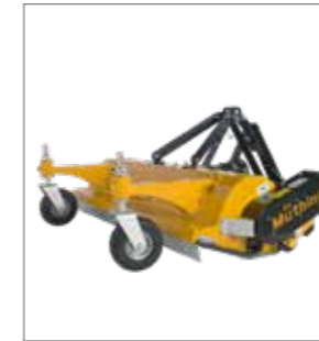
MU-C til frontmontering: Lavere koblingspunkter og en dybtliggende gearkasse (indgangsmdrejningstal på 1.000 eller 2.000 o/min).
