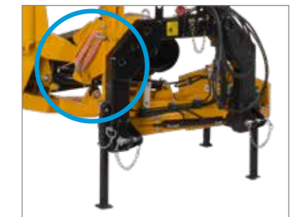
Automatisk låsende, mekanisk transportsikring, så man hurtigt kan køre af sted.
