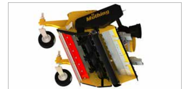
MU-Vario® for en optimeret indtags- og husform og en trinløst valgbar findelingsgrad, derved opnås ideel mulch kvalitet og oprævling.
