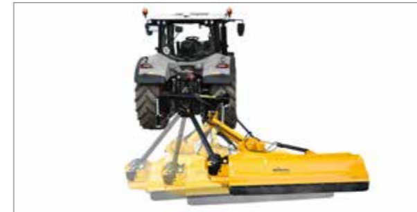
Et stort svingområde muliggør arbejde både bag og ved siden af traktoren. Snævre tilkørsler og siderabatter kan også mulches.
