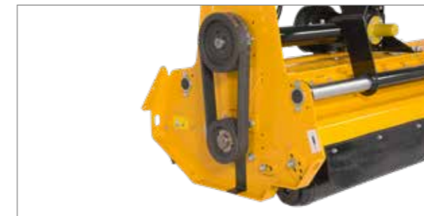
Mulige omdrejningstal på PTO-aksel på 540 eller 1.000 o/min.
